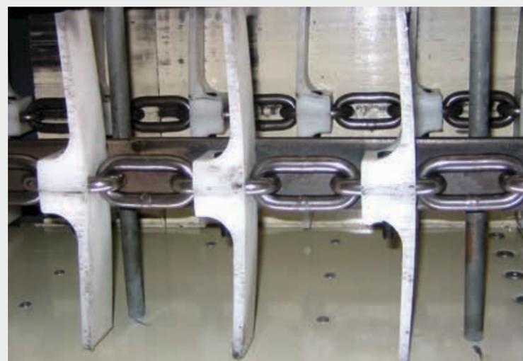
Применение плоскозвенной цепи для конвейера с системой Bolt 'N' Go
