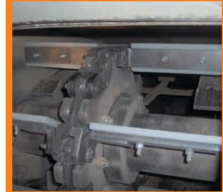
Лопатки UHMW на скребках "Т" Plate — сторона привода
