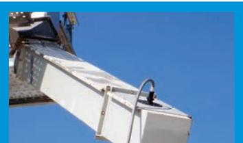
Датчик Binswitch установлен на горловине ковшовой нории (с SMP, BAS и переходником для кабелепровода)
