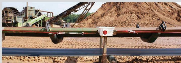
Шнуровой выключатель установлен на открытом ленточном конвейере
