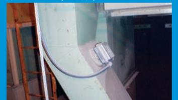
Датчик потока Auto-Set™ установлен заподлицо на участке разгрузки ленточного конвейера
