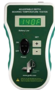
Средство проверки датчика ADB разработано для проверки на месте датчиков температуры подшипников регулируемой глубины (ADB) 4В. Устройство оборудовано встроенными органами управления и дисплеем температуры. Устройство нагревает датчик до требуемой температуры срабатывания и обеспечивает быструю, простую и реалистичную проверку датчика и системы контроля температуры.
