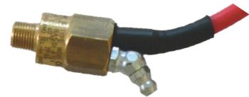
Серия **WDB8** — это датчики температуры с резьбовым хвостовиком для ввинчивания непосредственно в имеющееся отверстие для смазки с резьбой 1/4" BSP на корпусе подшипника. Каждый датчик оборудован ниппелем для смазки, позволяющим смазывать подшипник без необходимости демонтировать сам датчик. Серия WDB доступна либо с термистором положительного ТКС с различными заводскими предустановками граничных значений, либо с термистором отрицательного ТКС с настраиваемым пользователем граничным значением.
