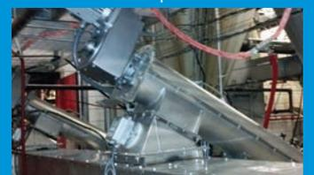
Датчик потока Auto-Set™ установлен заподлицо на участке разгрузки шнекового конвейера
