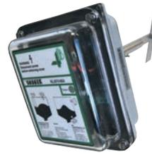
Поворотный флажковый переключатель используется для обнаружения высокого или низкого уровня сыпучего гранулированного материала в бункерах и силосах. Также его можно использовать как датчик затора в горловинах, если требуется отказоустойчивый датчик с длительным сроком службы. **RLI Shaker** вращается по часовой стрелке, затем протит часовой стрелки, а затем вибрирует для стряхивания скопившихся излишков материала.
