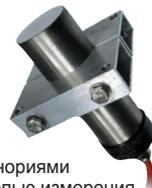
Датчик **WDA** обнаруживает перемещение объектов из черных металлов и предназначен для использования с ковшовыми нориями для обнаружения ковшей с целью измерения скорости и схода. WDA представляет собой бесконтактный датчик для обнаружения металлических объектов на расстоянии до 100 мм. Он также может обнаруживать болты из черных металлов, если используются ковши из пластика или нержавеющей стали 316 марки. Датчик используется совместно с ПЛК или устройством управления Watchdog или A400 Elite.
