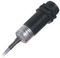
**Binswitch** представляет собой емкостной датчик для обнаружения заторов в желобах, выходных каналах и трубах. Доступен с 2 или 5-проводным подключением. Простой процесс полуавтоматической калибровки с помощью магнитов.
