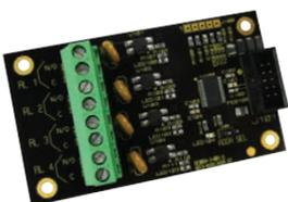
4 x выхода полупроводникового реле аварийного сигнала для следующих условий:
