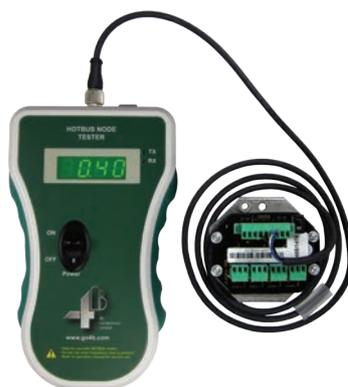
Устройство для проверки концентраторов Hotbus представляет собой портативное устройство проверки, которое можно использовать на месте для определения рабочего состояния любого узла и сети связи Hotbus с целью быстрого выявления проблем с проводкой или узлами.
