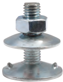
ЕВРОБОЛТ 4В Для стальных ковшей с глухими отверстиями: Болт, шестигранная гайка и большая колпачковая шайба.
