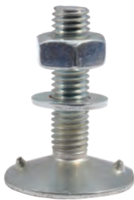
ЕВРОБОЛТ 4В Для стальных ковшей с плоскими отверстиями: Болт, шестигранная гайка и малая плоская шайба.
