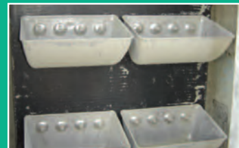
Ковши Starco Jumbo на ленте со стальным кордом 4B для цемента
