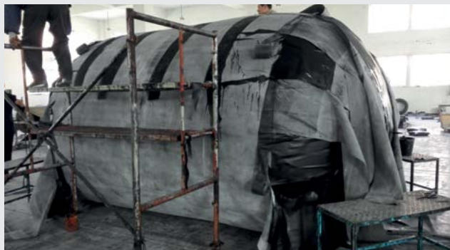
Рис.14: Слои шинного корда накладываются на баллон под углом 90°.
