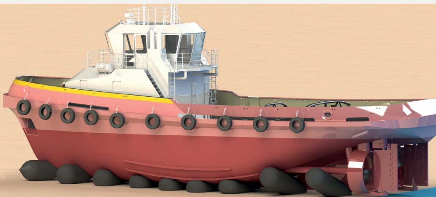
Рис 3: Спуск корабля с помощью пневматических баллонов
