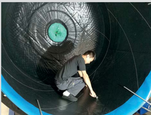
Рис.13: Нанесение слоев армирующего корда вручную
