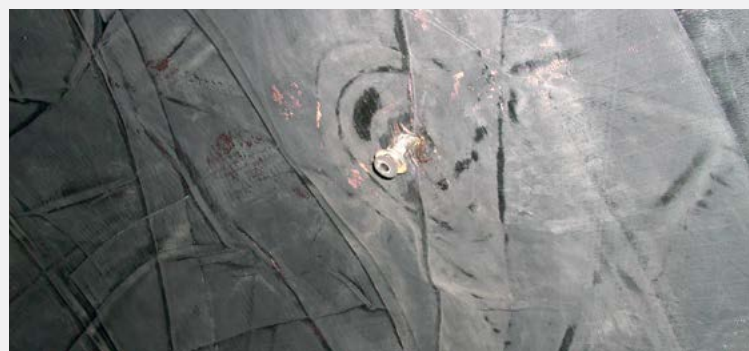
Рис.21: Поврежденный клапан сброса давления - изготовлен методом пневмо-баллонов
