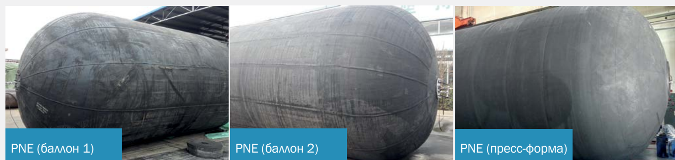
Рис.19: Внешний вид корпуса кранца (пневмо-баллоны 1 и 2 - неровная и шероховатая поверхность, пресс-форма - ровная и гладкая поверхность)
