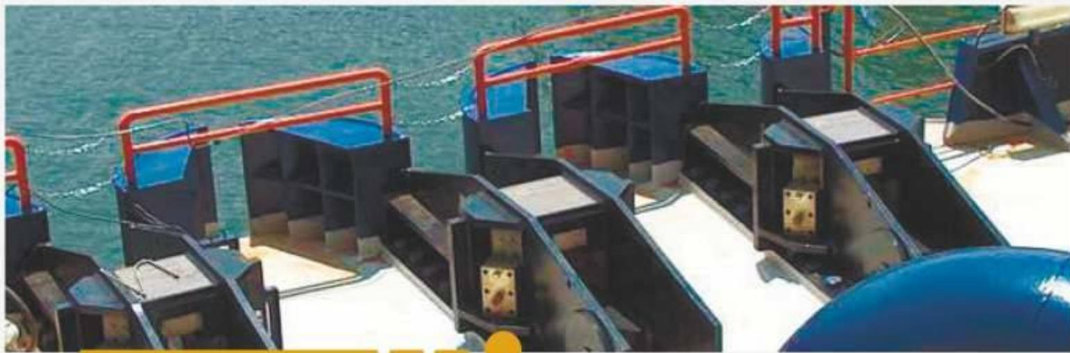
Цепные стопоры до 1210 тонн, для швартовки судна на растяжках или носом, закреплены на палубе, когда требуется аварийная отдача под нагрузкой и функция контроля нагрузки.
