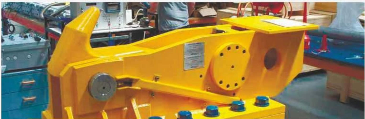
Буксирные быстроотдающиеся гаки Trelleborg были установлены более чем на 100 плавучих платформах СПГ для тандемной швартовки или швартовки носом во время отгрузки.
