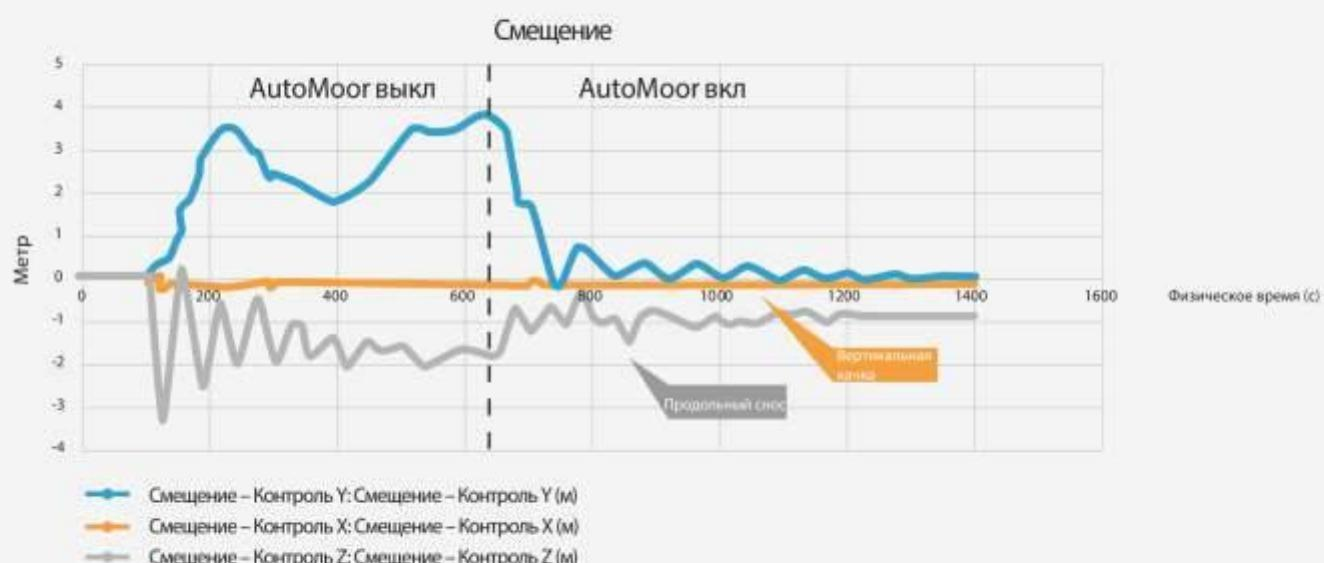
Сравнение перемещения судна, пришвартованного с помощью обычного оборудования и с помощью системы автоматической вакуумной швартовки AutoMoor с использованием программного обеспечения для анализа швартовки.
