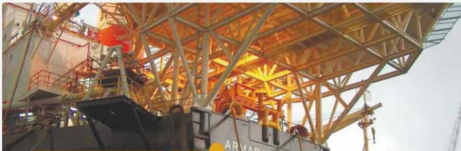
Модульное решение Trelleborg для модернизации tandemной швартовки для плавучей установки добычи и хранения нефти/газа, использующее буксирную лебедку с быстроотдающимся гаком и системой намотки.
