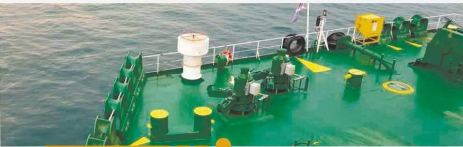
С 1972 года швартовные устройства с быстроотдающимися гаками позволяют надежно закреплять швартовные тросы, быстро и просто отдавать их, даже в случае рабочей нагрузки до безопасного предела.
